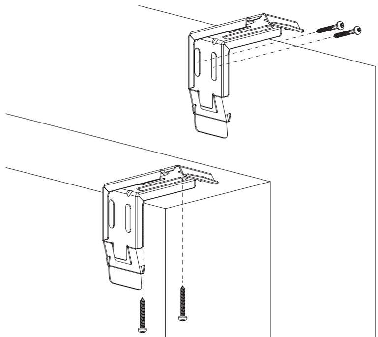
INSTALACIÓN Y MONTAJE SISTEMA CAJÓN CLS / (2/2)
