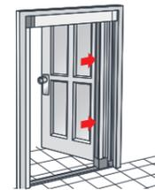
5.5 Spingere fortemente la zanzariera con la piastra di ancoraggio fino al luogo di installazione (profilo di piegatura della tela) in modo che la piastra di ancoraggio aderisca bene alla parte inferiore della zanzariera toccando la guida inferiore.
