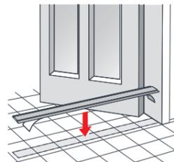
4.2 Rimuovere la parte bianca dal nastro e premerlo con forza a terra in corrispondenza della linea contrassegnata. Assicurarsi di premerlo verso il lato del profilo di piegatura della tela e tenere in conto che ci sono più di 7,5 mm di spazio su ogni lato della guida laterale.
