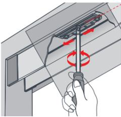
**Nota:** regolare la tensione del filo al centro del regolatore. Si noti che un'eccessiva tensione del filo può causare il malfunzionamento della zanzariera.
