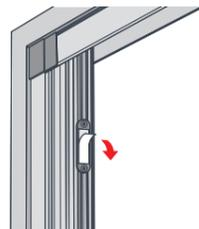
5.6 Fissare la guida laterale con le piastre di ancoraggio.
