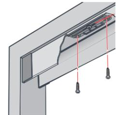
9.3 Le viti di fissaggio assicurano la corretta posizione del regolatore del filo sul profilo.
