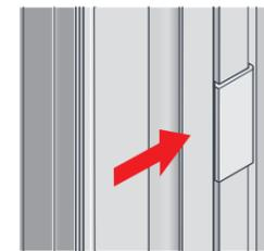
7.2 Quando la zanzariera è chiusa, l'ancoraggio viene agganciato alla barra di scorrimento e la barra di scorrimento viene estratta saldamente verso il profilo di piegatura della tela.
