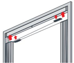
9.4 Installare sul regolatore del filo la seconda unità della zanzariera plissettata.
