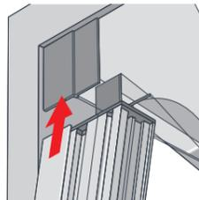
5.2 Inserire la zanzariera e la guida laterale (unite con il magnete) nella guida superiore. La guida laterale deve essere inserita nel foro in cui si trova la testata più grande della guida superiore e posizionare la parte inferiore della zanzariera sopra la guida inferiore fissa.
