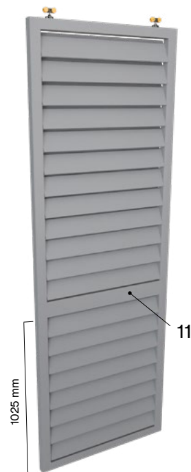
Travesaño horizontal Altura hoja > 1800 mm. Anchura hoja < 2000 mm.
