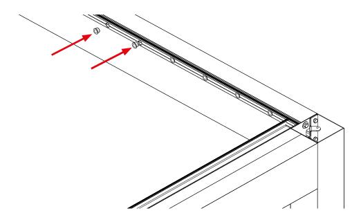
Per installare le lame senza LED, disporremo di alcuni set di boccole sistema perno O-210 formati da una boccola di plastica da 16,4x25 mm e da un rullo di acciaio inossidabile retrattile.
