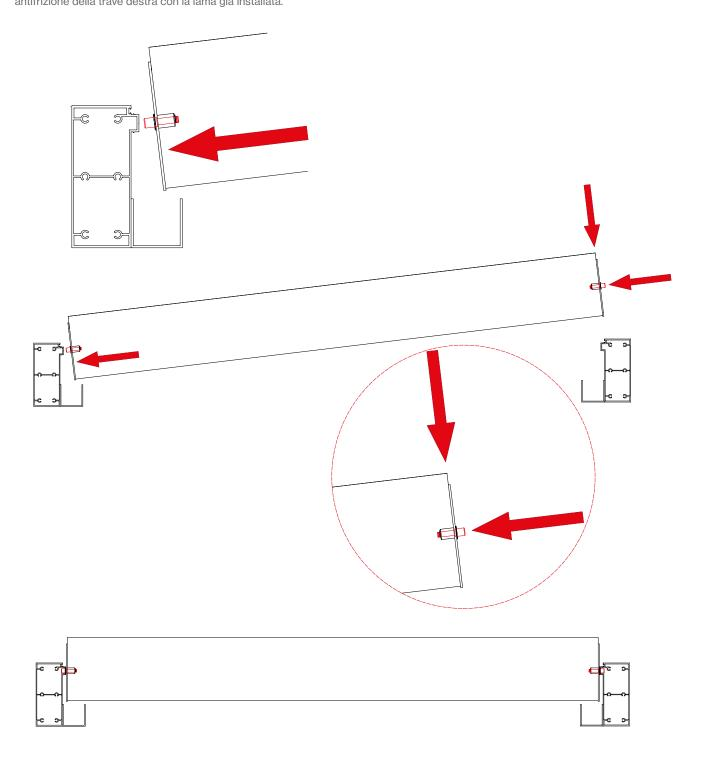
Una volta arrivati al foro delle lame con LED, realizzare il collegamento del connettore e inserirlo all'interno della trave (come mostrato nelle immagini seguenti).
