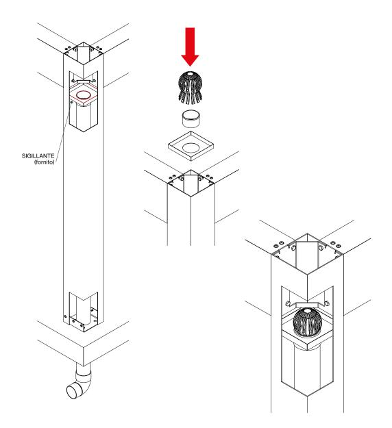
Infine, applicare il sigillante (in dotazione) lungo tutto il perimetro del collettore e dell'adattatore. Seguire quanto mostrato nell'immagine (sigillante in rosso) e inserire il filtro universale nell'adattatore.
