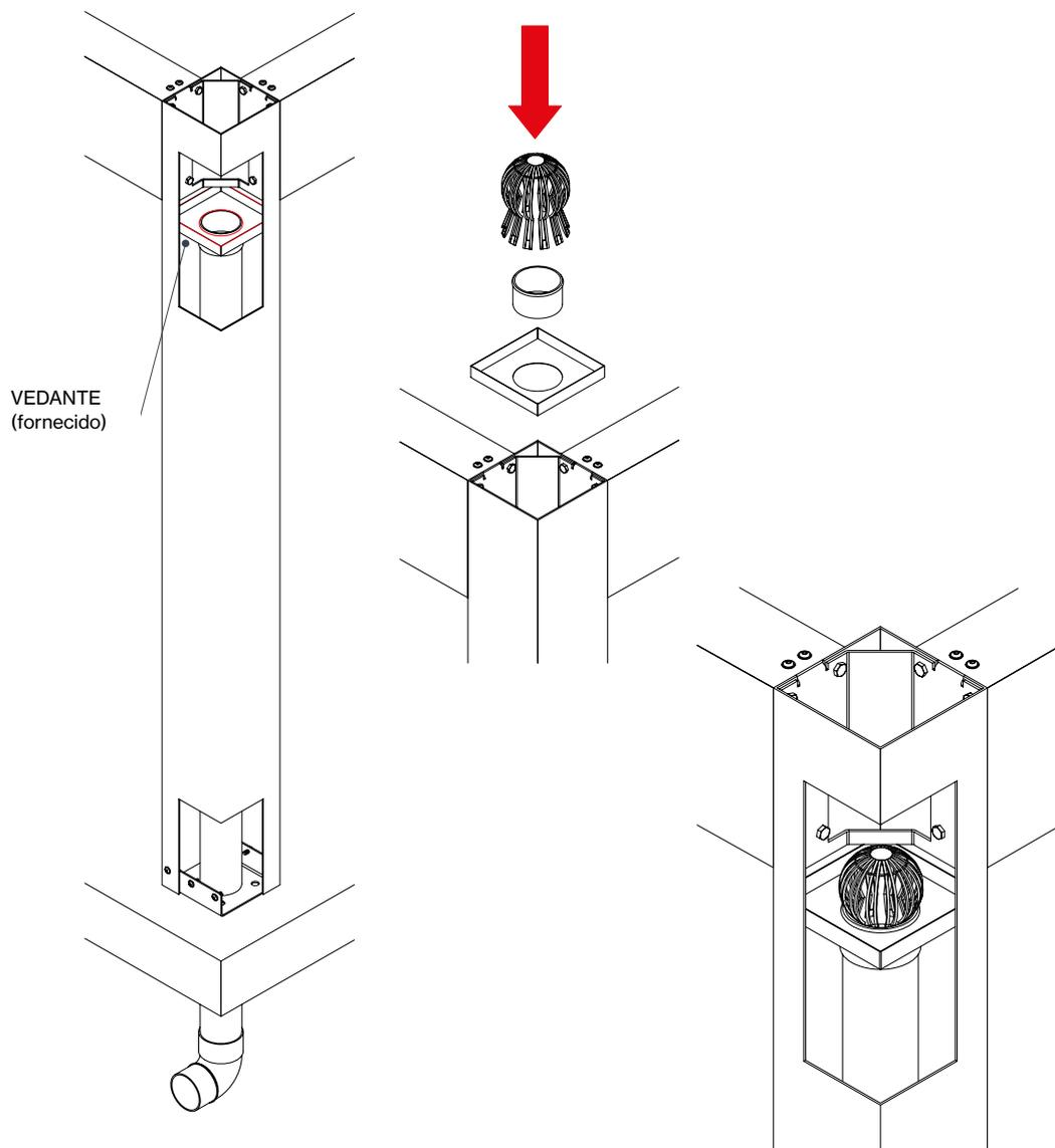
Por fim, aplique o vedante (fornecido) em todo o perímetro do tabuleiro coletor e do adaptador. Como mostrado na figura (vedante a vermelho) e inserir o suporte universal da lâmina no adaptador.
