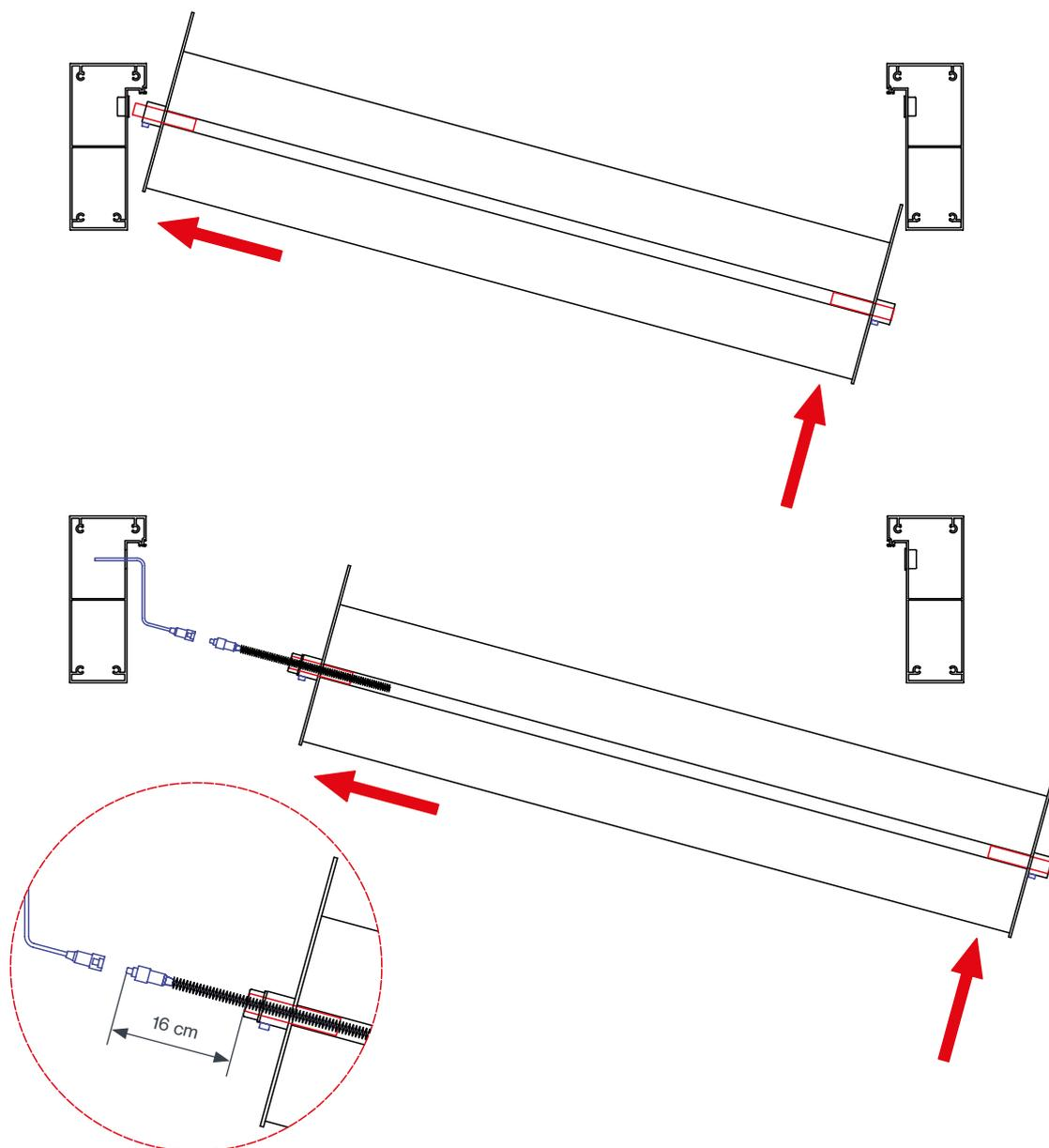
Instalar as lâminas inclinando-as com as abas dos tampas para baixo, introduzindo primeiro o eixo fixo (esquerda) e posteriormente o eixo móvel (direita).
