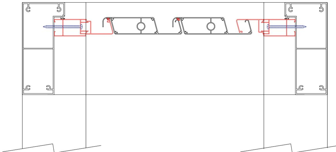
Verifique se todos os orifícios do perfil “U” coincidem com os pontos de união M6 da viga. Em caso afirmativo, aplique vedante entre o perfil em “U” e a viga. depois de aparafusar os perfis com os parafusos USL (ISO 7380) A2 M6x16.
