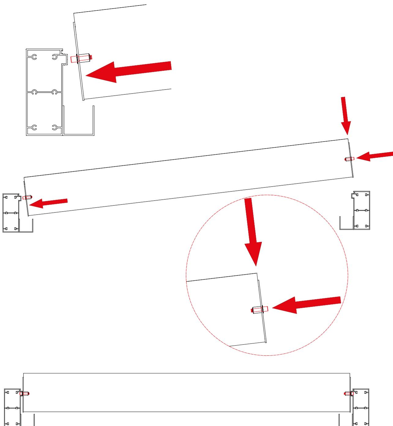
Una volta arrivati al foro delle lamelle con LED, realizzare il collegamento del connettore e inserirlo all'interno della trave (come mostrato nelle immagini seguenti).
