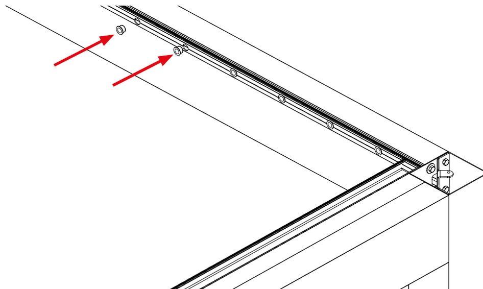
Per installare le lamelle senza LED, disporremo di alcuni set di capsule sistema perno O-210 formati da una capsula di plastica da 16,4x25 mm e da un rullo di acciaio inossidabile retrattile.
