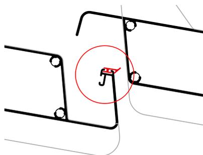
Posa della guarnizione sulle lamelle (Passaggio lama 150)
