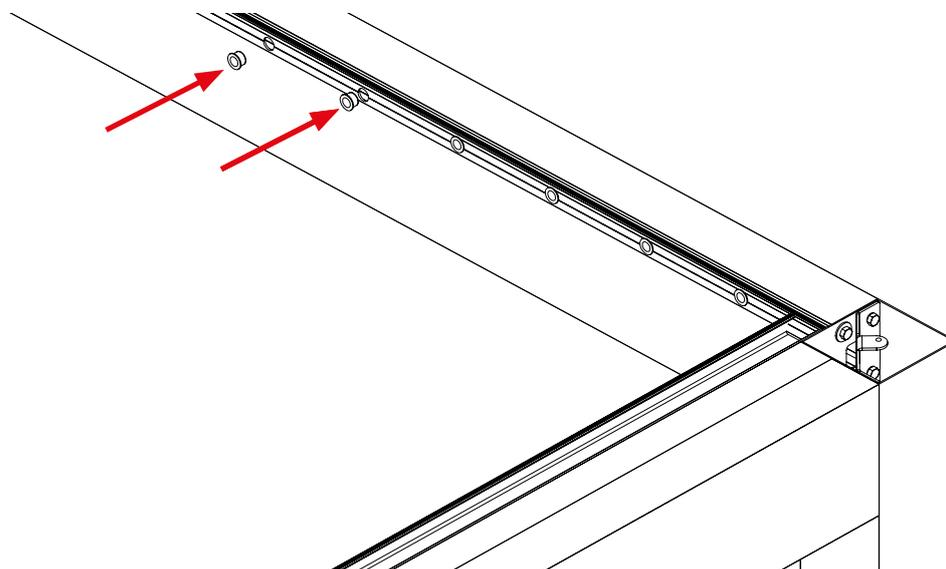
Para instalar as lâminas sem LED, disporemos de conjuntos de buchas de sistema pivô O-210, formados por uma bucha de plástico com 16,4x25 mm e um eixo de aço inoxidável retrátil.
