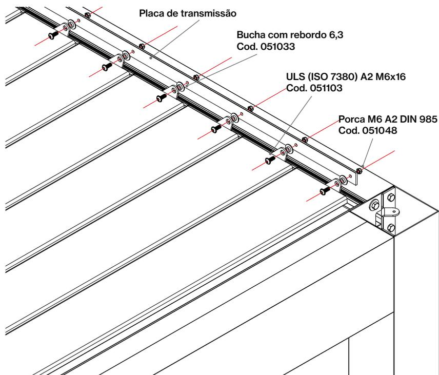
Una as placas as tampas com os parafusos correspondentes ULS (ISO 7380) A2 M6x16, buchas de plástico com rebordo de 6,3 mm e com a porca M6 DIN 985.
