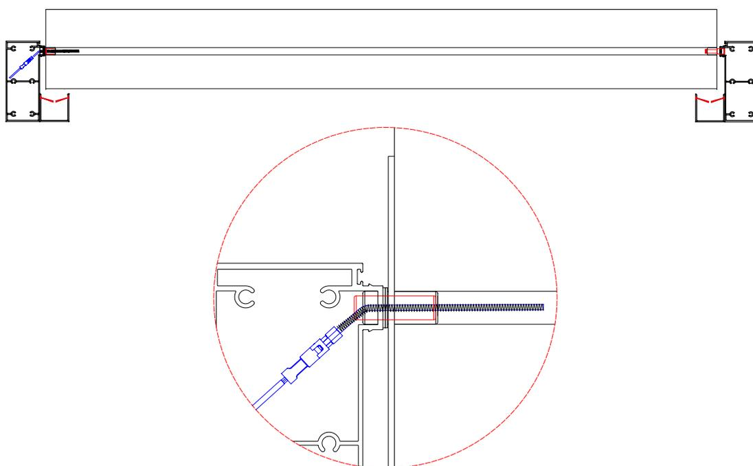
Quando se for instalar a 5ª ou a 6ª lâmina, chegaremos à zona onde os mecanismos para instalar o **jogo tandem completo** código estarão dispostas nas placas de transmissão, cod: 050307.
