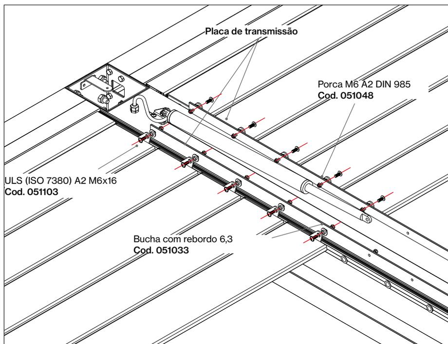
Se desejar, no caso das placas das vigas **esquerda** e **direita**, poderá instalá-las quando todas as lâminas estiverem colocadas.
