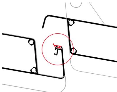
Colocação da borracha nas lâminas (Passo lâmina de 150 a 160)
