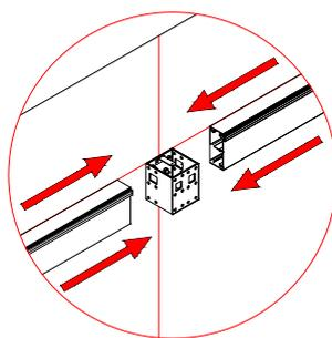
Coloque as extremidades da viga de fecho de corte reto contra a secção da coluna fixada à parede e aparafuse.
