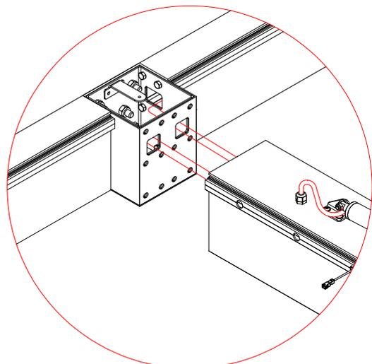
Unir a viga **central** com as vigas de fecho e de abertura. .
