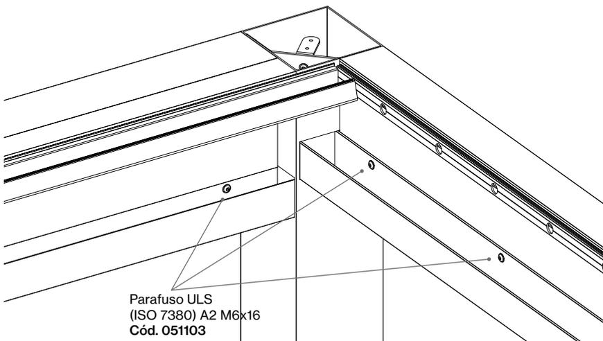
Verifique se todos os orifícios do perfil "U" coincidem com os pontos de união M6 da viga.
