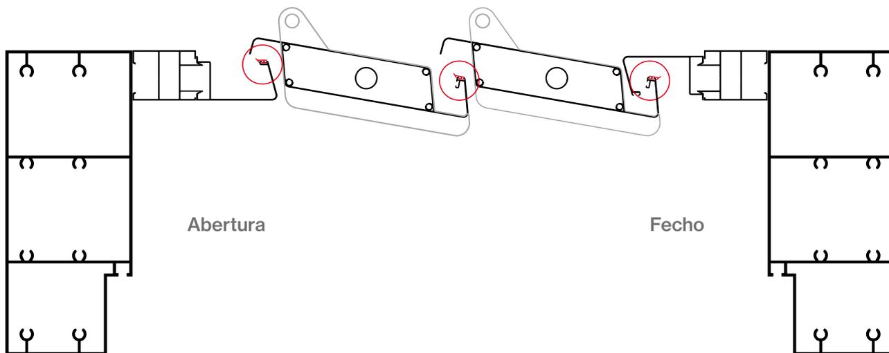
Colocação da borracha na calha de clip de abertura.
