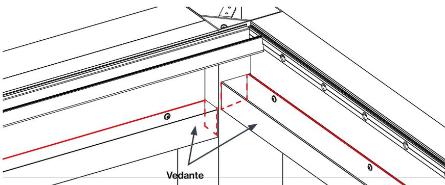
Utilize o vedante fornecido para a selagem dos canais "U" com as vigas e juntas, nas zonas onde se possam verificar fugas de água.
