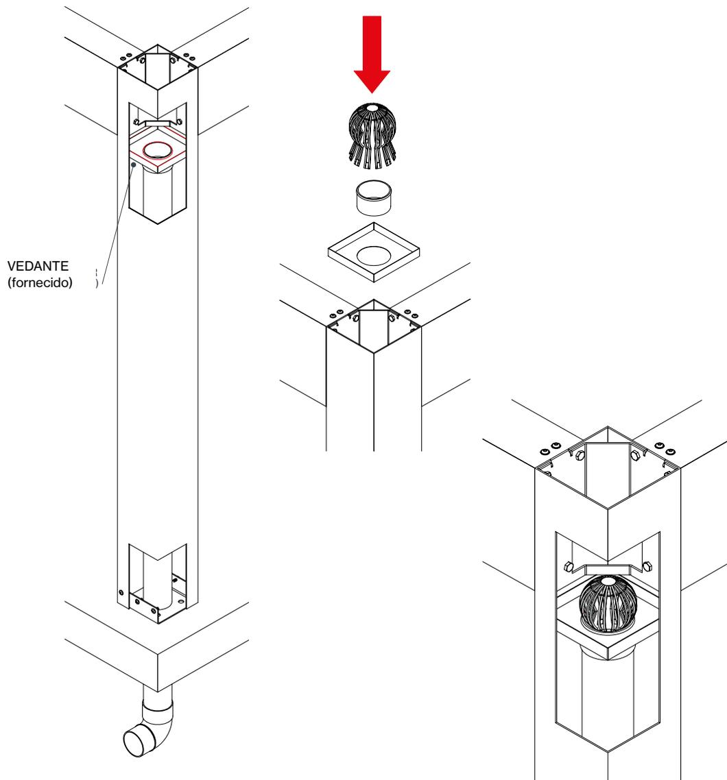
Por fim, aplique o vedante (fornecido) em todo o perímetro do tabuleiro coletor e do adaptador. Como mostrado na figura (vedante a vermelho) e inserir o suporte universal da lâmina no adaptador.
