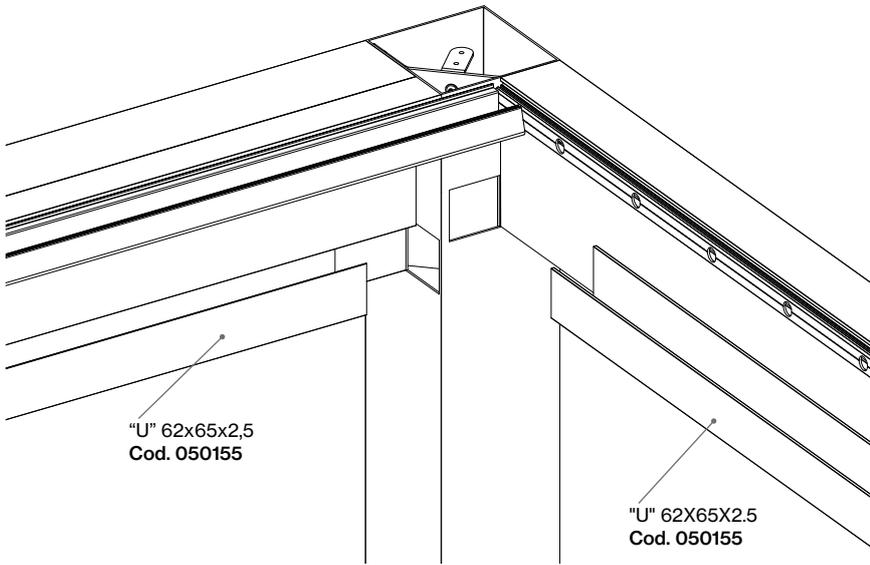
Instalar os canais de evacuação em "U" nas vigas **esquerda** e **direita**, introduzindo para tal a extremidade do canal pelo orifício de evacuação mecanizado nas colunas A e B e colocá-lo no mesmo nível da viga e das colunas C e D.
