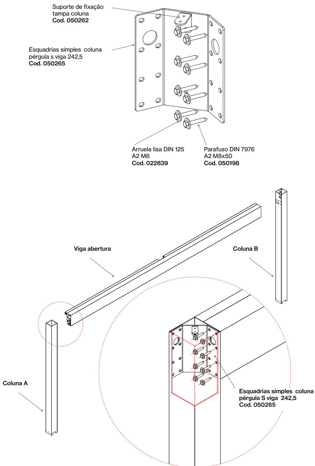
Tendo as vigas de abertura e fecho unidas às colunas, fixar as mesmas sobre as bases de coluna de superfície de soleira com a ajuda dos parafusos ULS (ISO 7380) A2 M6x16 mm. como mostrado na imagem.
