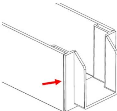
4. Pressione os 3 lados da peça: inferior, esquerdo e direito (marcados com setas vermelhas) para selar a peça contra a calha.
