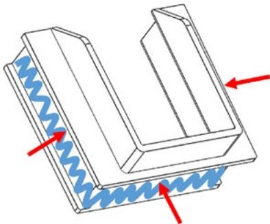
2. Installare l'elemento nella grondaia dall'interno della colonna, facendo attenzione a non rimuovere il silicone.
