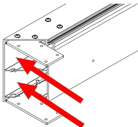
Controllare la planarità della trave di chiusura rispetto alla base, la sua altezza rispetto al piano e che tutti i segni rispetto ai fissaggi della base siano a 90°.
