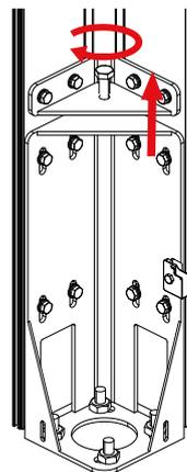
Al termine del montaggio, dopo la sezione 6.1 Coperchio di chiusura. Quando si regola l'altezza della colonna, alla base vengono fissati due pezzi di rifinitura. Le rifiniture si fissano con il silicone.
