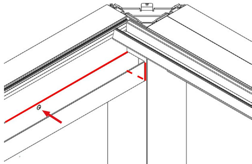
Verificare che tutti i fori del profilo a "U" corrispondano alla lavorazione M6 delle travi. Se tutto corrisponde, applicare del sigillante tra il profilo a U e la trave e intorno ai fori delle viti, quindi avvitare i profili tra loro con viti ULS (ISO 7380) A2 M6x16.
