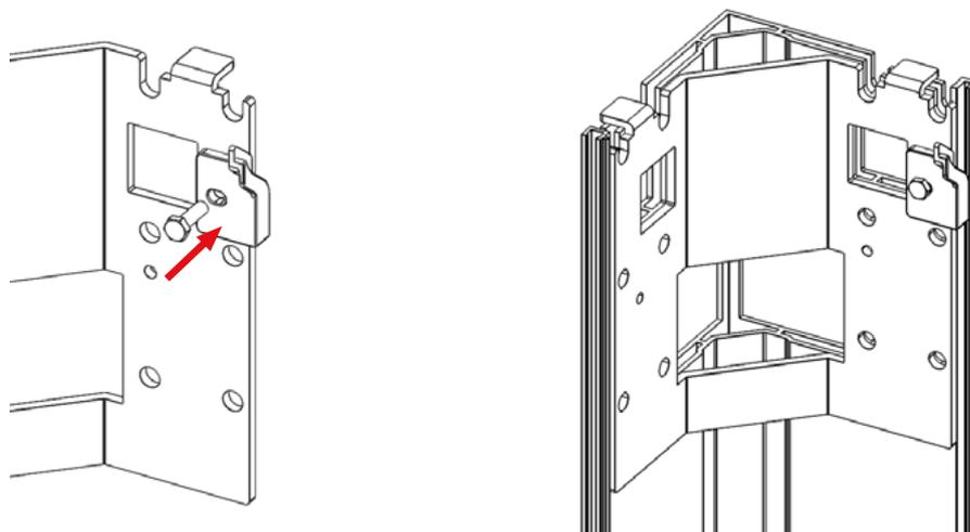
Controllare la planarità della trave di chiusura rispetto alla base, la sua altezza rispetto al piano e che tutti i segni rispetto ai fissaggi della base siano a 90°. Per un funzionamento ottimale della pergola, è fondamentale installare correttamente la trave e le basi delle colonne.
