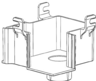
9. Posizionare il collettore sotto le estensioni della grondaia.
