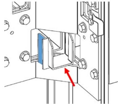
3. Una volta montato, l'elemento deve fare contatto con l'estremità della grondaia come mostrato nell'immagine.
