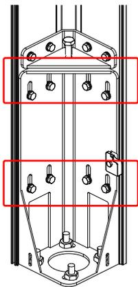
Aparafusar o parafuso M12 para levantar a coluna até a viga estar nivelada e apertar novamente os 8 parafusos da base.
