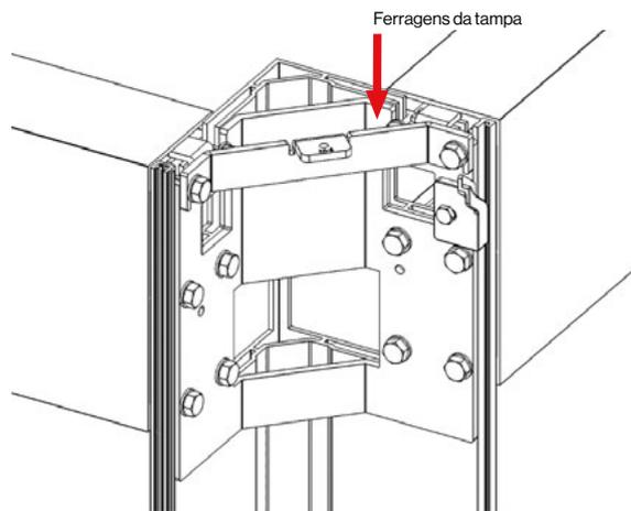
Repetir o procedimento com as restantes vigas, pondo primeiro a coluna e depois a viga.
