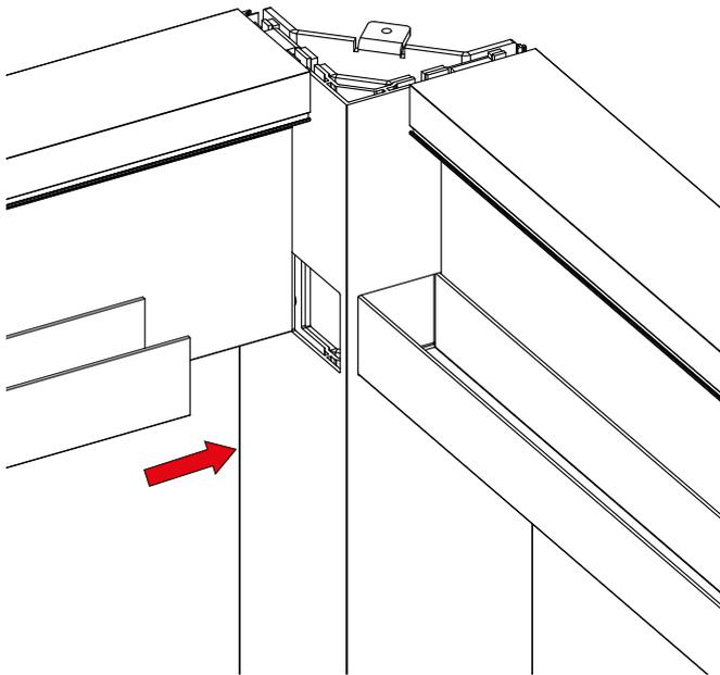
Verifique se todos os orifícios do perfil "U" coincidem com os pontos de união M6 da viga. Em caso afirmativo, aplique vedante entre o perfil em "U" e a viga. depois de aparafusar os perfis com os parafusos USL (ISO 7380) A2 M6x16.
