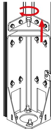
No final da montagem, após a secção 6.1 Tampa de cobertura. Quando se ajustar a altura da coluna, devem ser fixadas à base duas peças de cobertura. Para fixar as coberturas, devem ser seladas com silicone.
