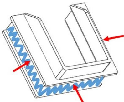
2. Instale a peça na calha a partir do interior do pilar, tendo o cuidado de não remover o silicone durante o processo.
