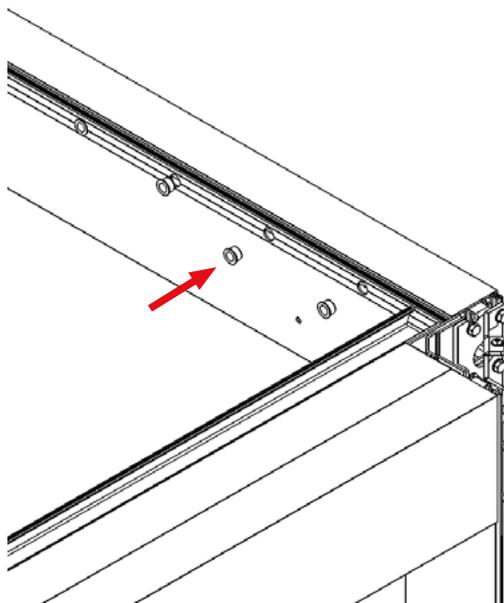
Para instalar as lâminas sem LED, disporemos de conjuntos de casquilhos do sistema de articulação O-210, constituídos por um casquilho de plástico de 16,4x25 mm e um eixo retrátil em aço inoxidável.
