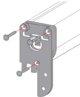
**2.4 Installazione del kit di fissaggio rapido**
