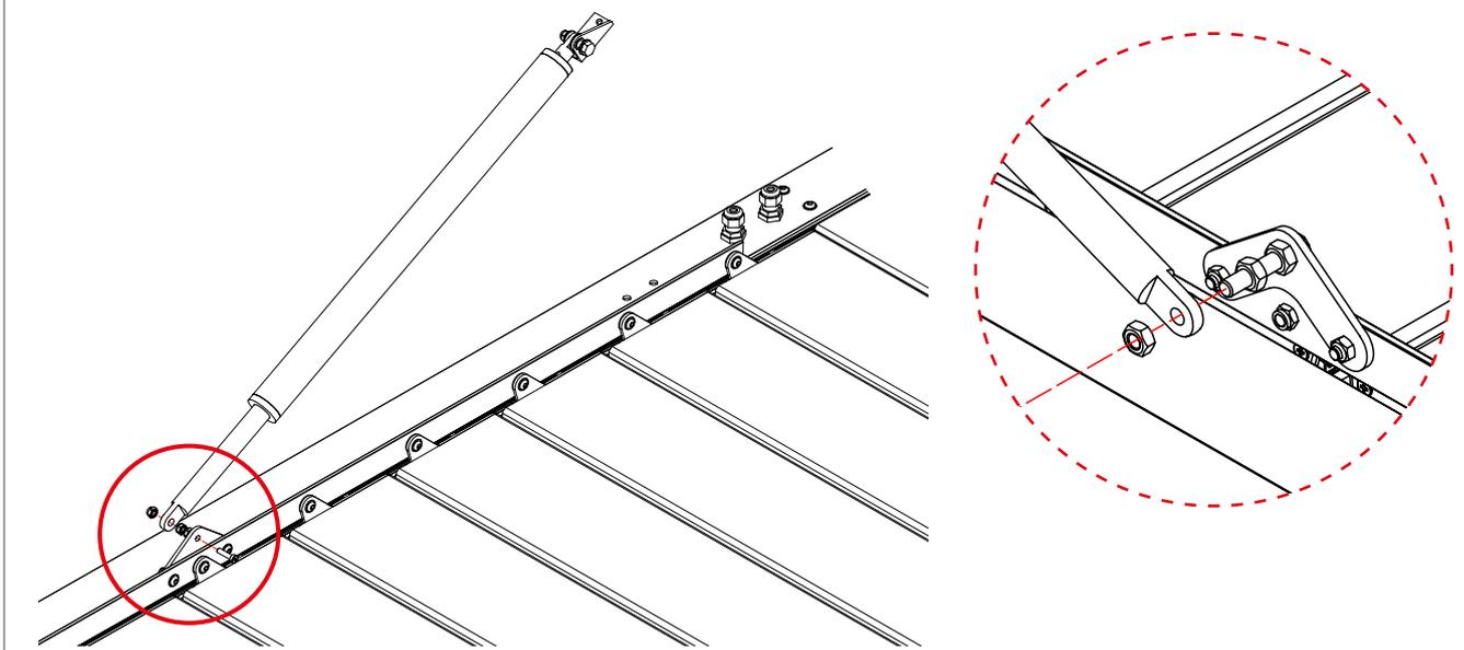
3. Deslocar o motor abrindo a pérgula, até o seu suporte poder ser aparafusado nos orifícios de rosca da viga.
