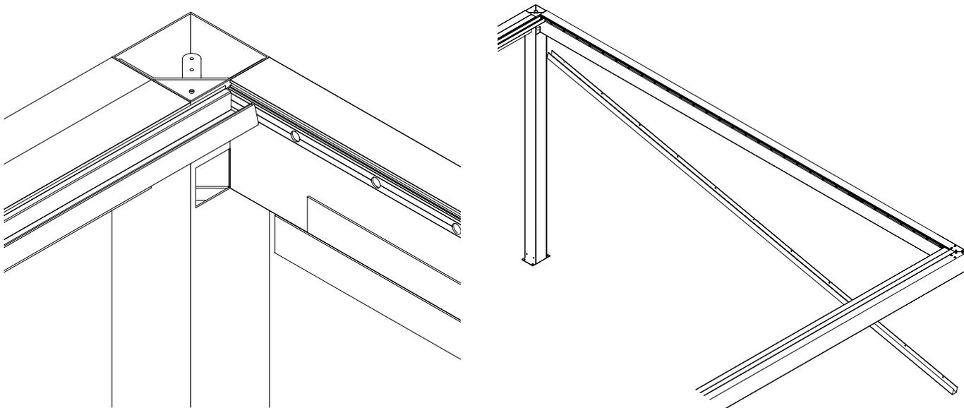
Verifique se todos os orifícios do perfil “U” coincidem com os pontos de união M6 da viga. Em caso afirmativo, aplique vedante entre o perfil em “U” e a viga. depois de aparafusar os perfis com os parafusos USL (ISO 7380) A2 M6x16.
