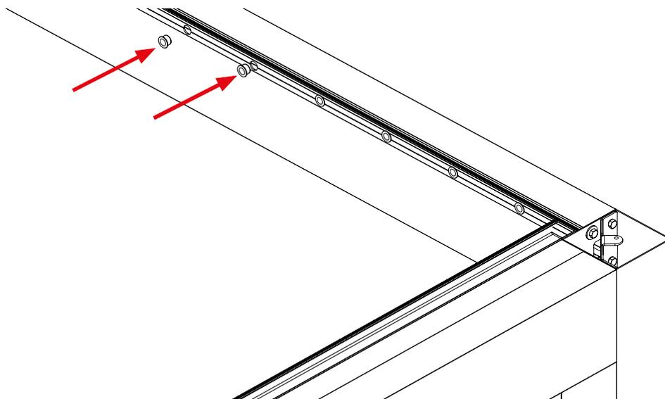
Para instalar as lâminas sem LED, disporemos de conjuntos de casquilhos do sistema de articulação O-210, constituídos por um casquilho de plástico de 16,4x25 mm e um eixo retrátil em aço inoxidável.
