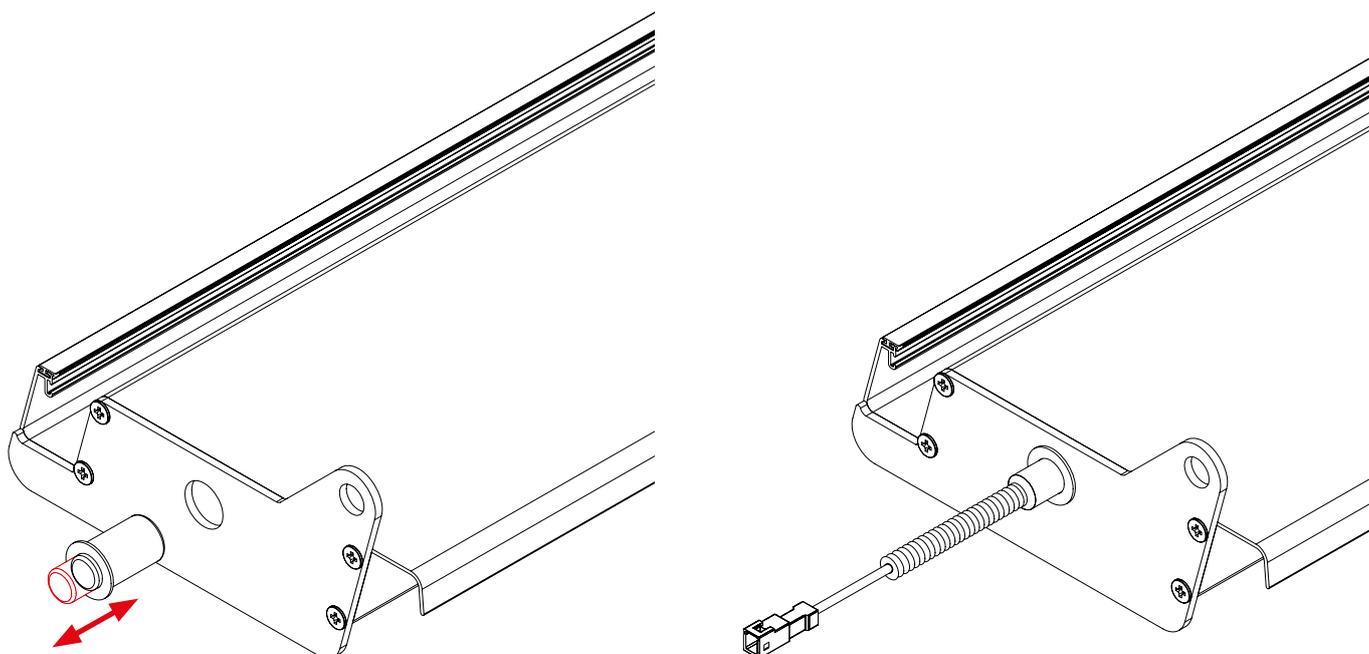
Para a instalação das lâminas com LED, estas já deverão vir previamente instaladas num dos lados com um eixo oco por onde sai o conector de LED com uma mola de proteção e no outro lado será necessário colocar o eixo retrátil O-210.
