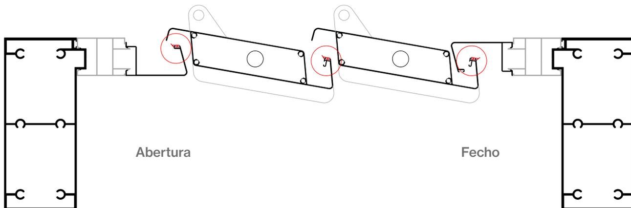
Colocação da borracha na calha de clip de abertura.
