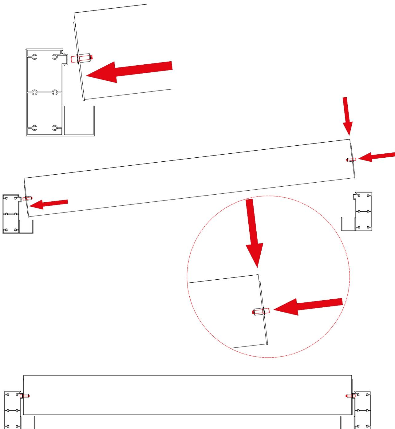
Quando chegar ao orifício onde as lâminas com LED estão instaladas, proceda à ligação do conector e introduza-o no interior da viga (tal como se indica nas imagens abaixo).
