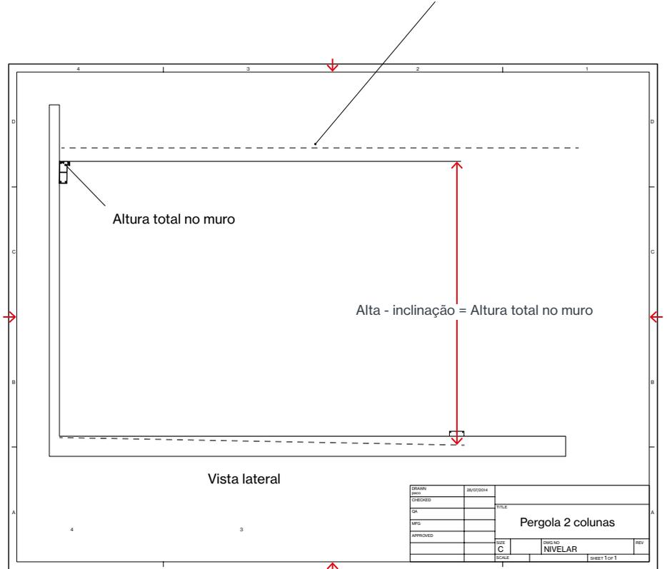
Situe as bases das colunas de acordo com as medidas do plano e com o desnível do pavimento, tendo em conta que estas devem formar um ângulo de 90° relativamente ao muro de apoio da pérgula.
